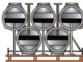
Palletopstelling Gemonteerde levering.
